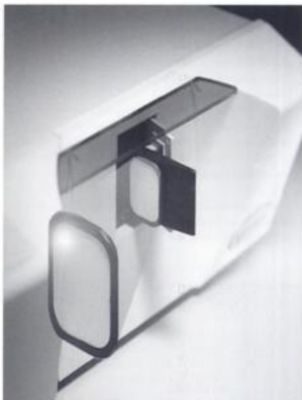
Fig. 2-7. Sistema de captación con placas de fósforo.
