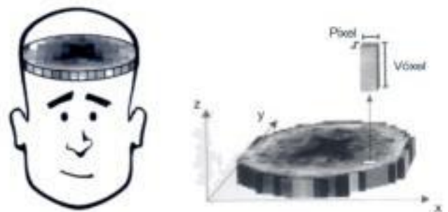
Fig. 2-72. Esquema de un corte axial de cráneo. Concepto de píxel y vóxel.
