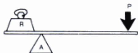
Fig. 17-31. Leyes físicas que rigen el uso de los elevadores: palanca de primer género. A, punto de apoyo; R, resistencia; P, potencia.
